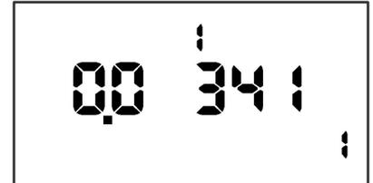
Danach wird die abgegebene Energie in C angezeigt. In dem Beispiel oben rechts als 0.0341C.
